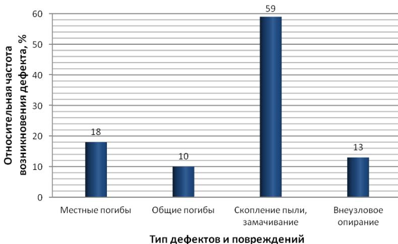
Рис. 5. Относительная частота возникновения дефектов и повреждений по стропильным фермам предприятий энергетики
