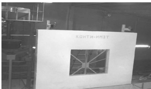
Рис. 2. Трехслойная теплоизоляционная панель типа 210
