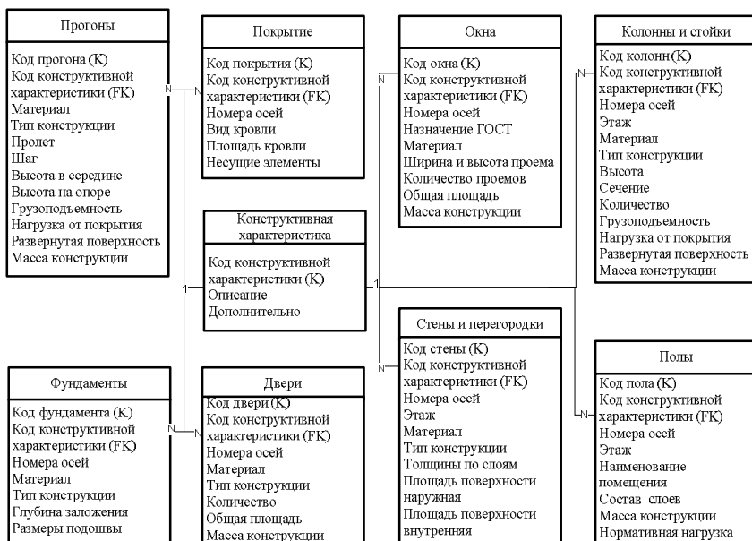
Рис. 2. Состав элементов подсистемы «Конструктивная характеристика»
