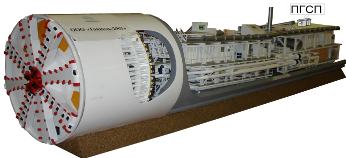
Рис. 4. Размещение подземного горноспасательного поста на ТПМК «Херренкнехт»
