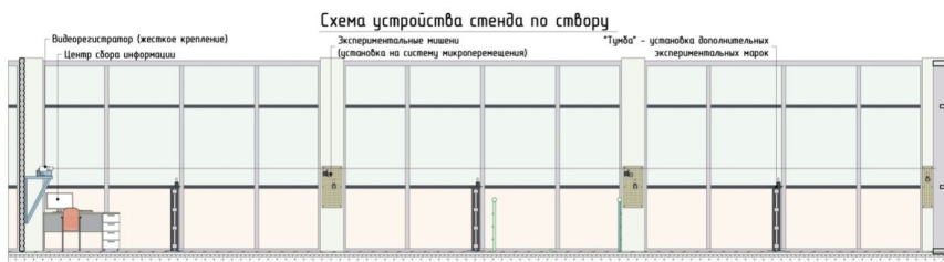
Рис.3.1. Общее компоновочное решение стенда «Створ»
