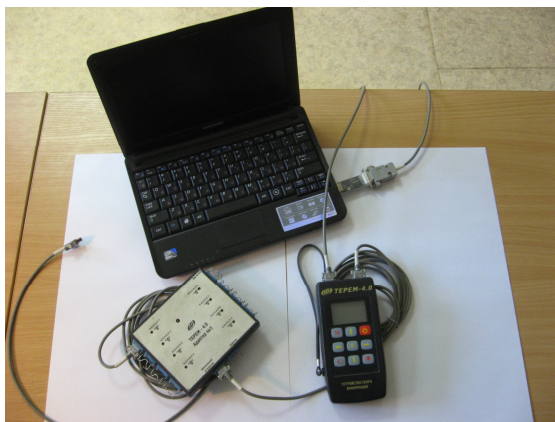
Рис. 3. Подключение регистрирующего прибора «Терем-4» к ПК
