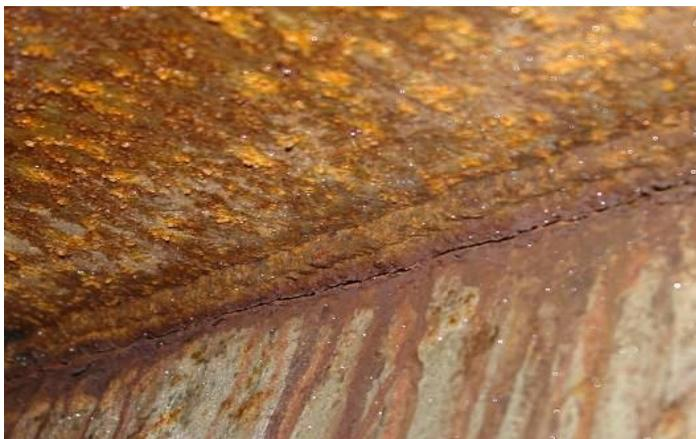
Рис.9. Кран-перегрузатель. Трещина в стыке пояса и стенки
