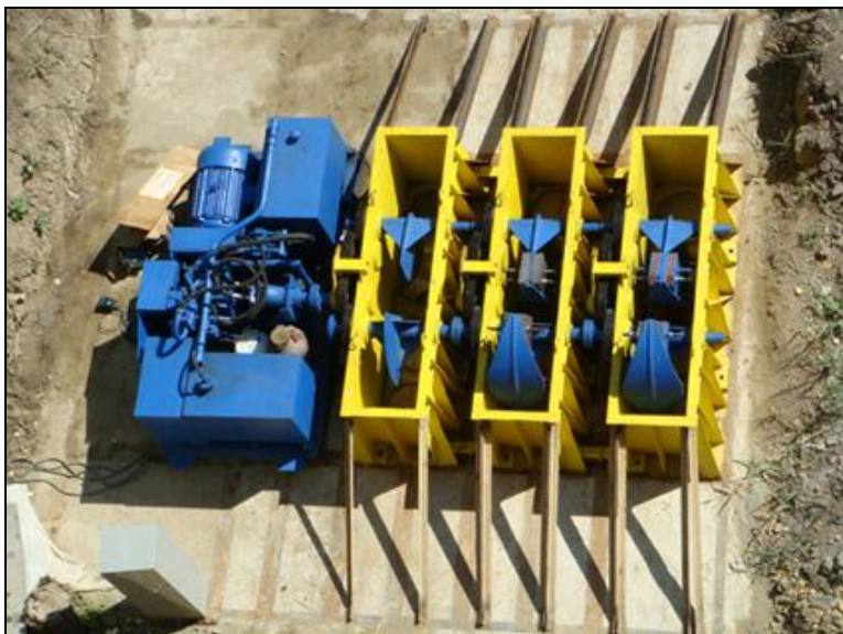
Рис.3. Общий вид вибромашины, подготовленной к испытаниям здания
