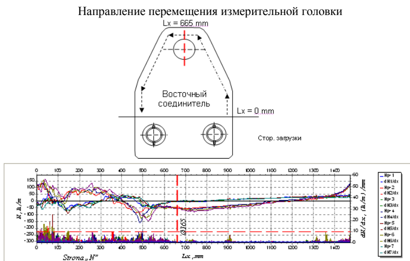
Рис.5. Распределение градиента магнитного поля по периметру листов ствола
