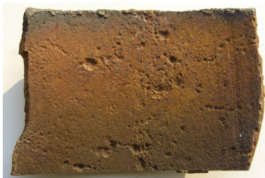
Рис. 4. Коррозионные повреждения внутренней поверхности баллона
