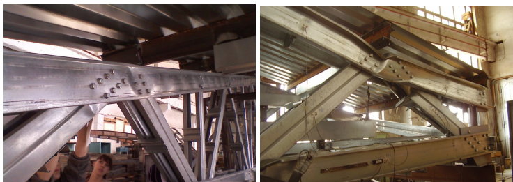
Рис.3. Образование шарнира пластичности в узле
