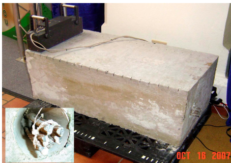
Рис. 9. Экспериментальный блок из бетона с моделью тросового канала. Незабетонированная часть канала справа
