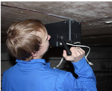
Рис. 7. Процесс сканирования конструкции антенным устройством томографа
