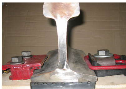
Рис. 3. Общий вид крепления БКП к колонне с применением низко модульных прокладок
