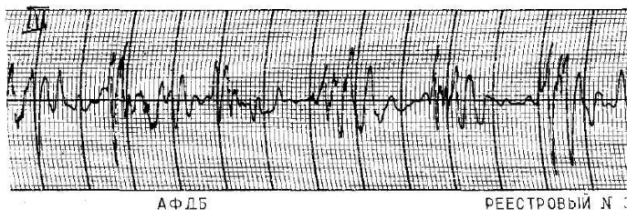
Рис.2. Виброграмма вертикальных перемещений стропильной системы в точке «В»
