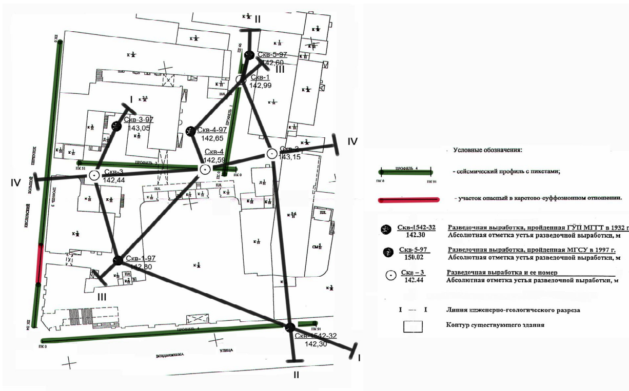
Рис. 4. План участка с указанием линий сейсмических профилей и расположения разведочных выработок
