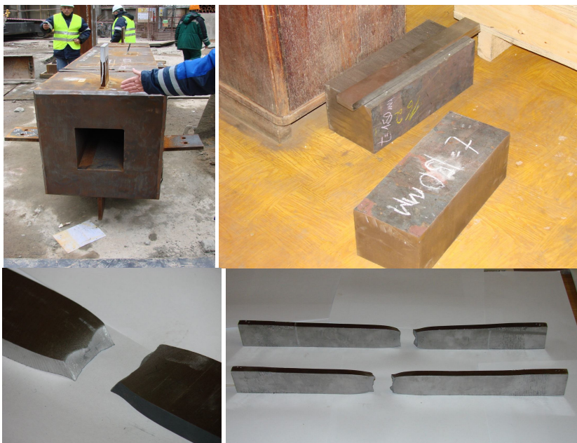
Рис.4. Колонна коробчатого сечения с габаритами 750×750 мм и толщиной стенки 230 мм, испытания проката
