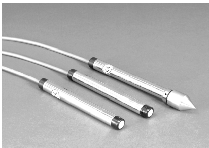
Рис. 9. Внешний вид скважинных пьезометров
