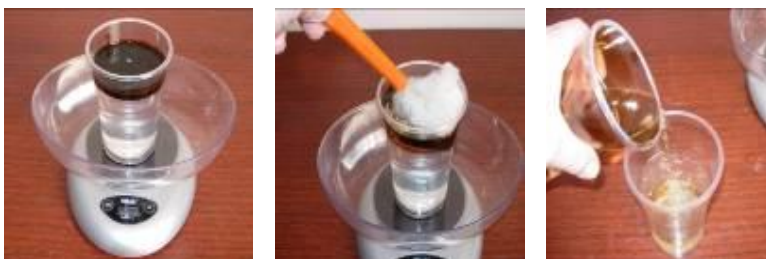
Рис. 4. Результат нефтепоглощения с поверхности воды тонким волокном
