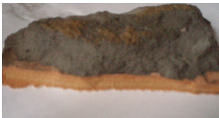
Рис. 5. Хорошее сцепление клеящего раствора с керамической плиткой
