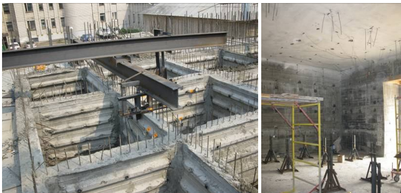
Рис. 3. Установка измерителей углов закручивания ребер К1-К6 и прогибомеров П1-П9
